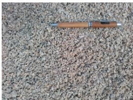
Sable filtrant DTU 64.1 (dispositifs pour assainissement autonome).
