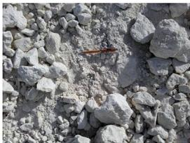
Utilisé pour les remblais d'accès de chantiers, remblais de dalles de maisons ou remblais industriels, remblais de contour de maisons ou d'industries.
